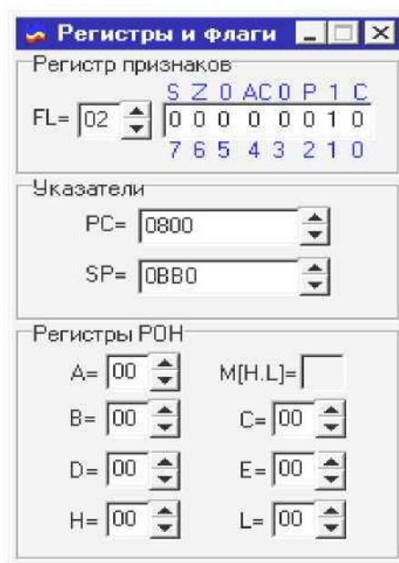
8.6-rasm. YMIK-80 elektron standiga o‘matilgan K580BM80 protsessorining ichki registrlari.
